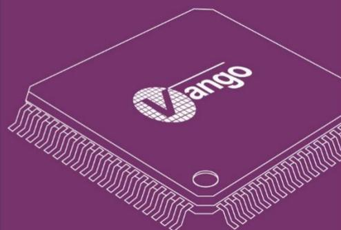
V9160 是一款三相计量芯片，支持多种模式的全波和基波能量计量，并支持监测多种电网事件。同时，采样数据可通过 DMA 以 SPI 协议传输出去。
